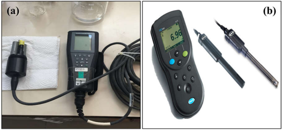
Şekil 2.1. (a) Klorür, amonyum ve nitrat ölçümlerinde kullanılan YSI Procomm II Instruction Manuel multiparametre ölçüm cihazı, (b) pH, çözünmüş O 2 , iletkenlik, TDS ve tuzluluk ölçümlerinde kullanılan Hach-Lange HQD portatif multiparametre ölçüm cihazı
