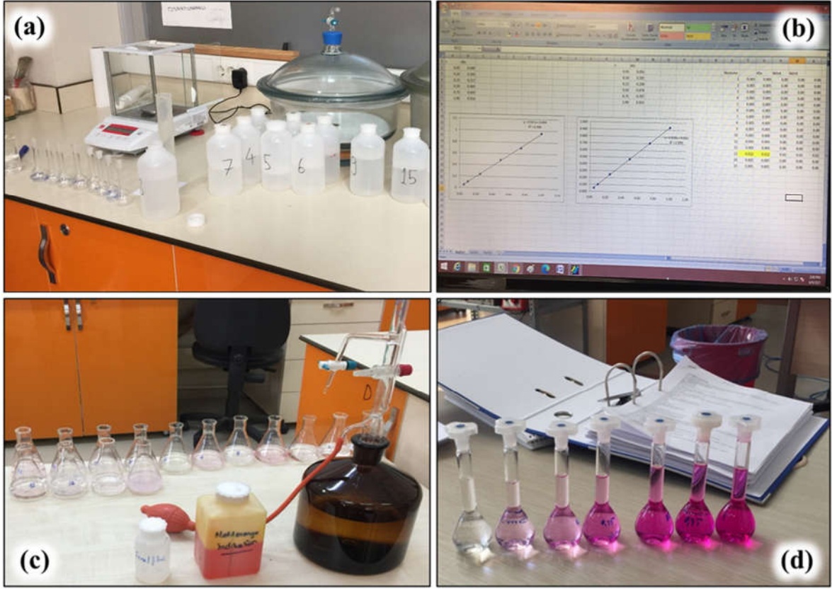
Şekil 2.2. (a) Analiz öncesi hazırlıklar, (b) Nitrit tayini için çizilen kalibrasyon grafikleri, (c) Alkalinite çalışması için kurulan deney düzeneği, (d) Nitrit analizinde hazırlanan standart çözeltiler
