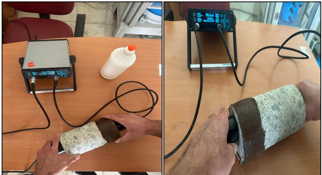
Şekil 57. Ultrasonik dalga geçiş hızı deneyinden görüntü
