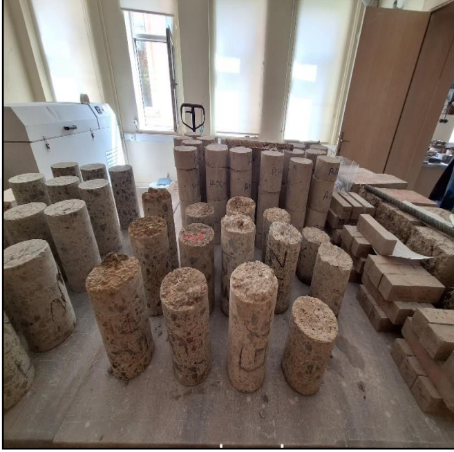
Şekil 54. Yarmada çekme dayanım deneyine tabi tutulan karot numuneler
