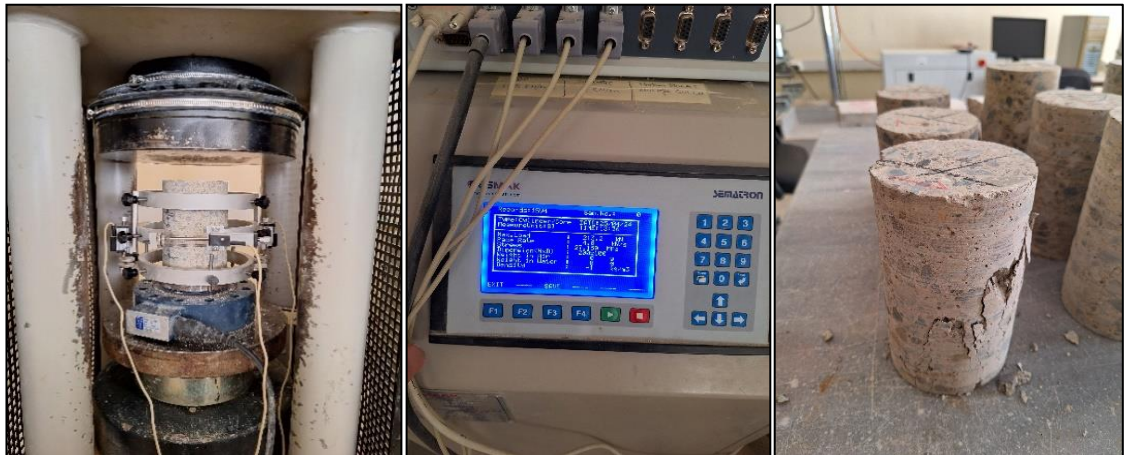
Şekil 43. Basınç dayanım deneyinden görüntüler
