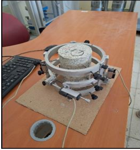
Şekil 45. Yer değiştirmelerin ölçümünde kullanılan cihaz
