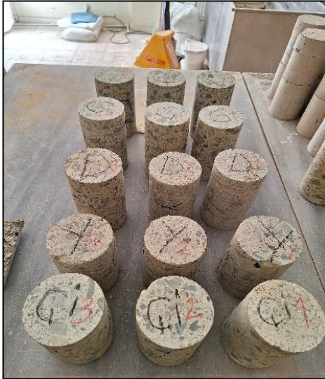
Şekil 42. Basınç dayanım deneyine tabi tutulan karot numuneler
