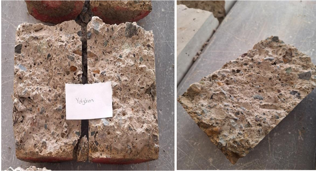
Şekil 56. Sırasıyla Yolgören ve Derecik mahallesine ait yarmada çekme dayanım deneyinde kırılmış numuneler
