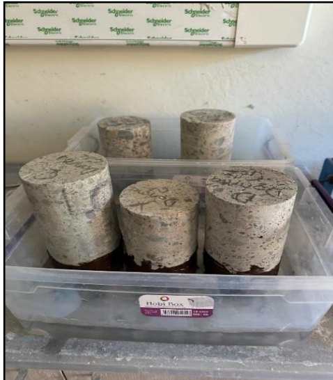
Şekil 60. Kapiler su emme deneyinden görüntü
