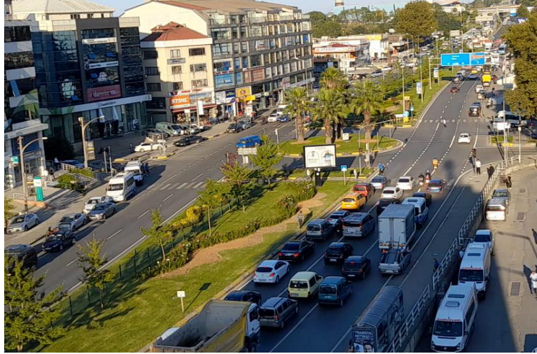
Şekil 2.13. Sinyalizasyondan kaynaklı aşırı kuyruklanma
