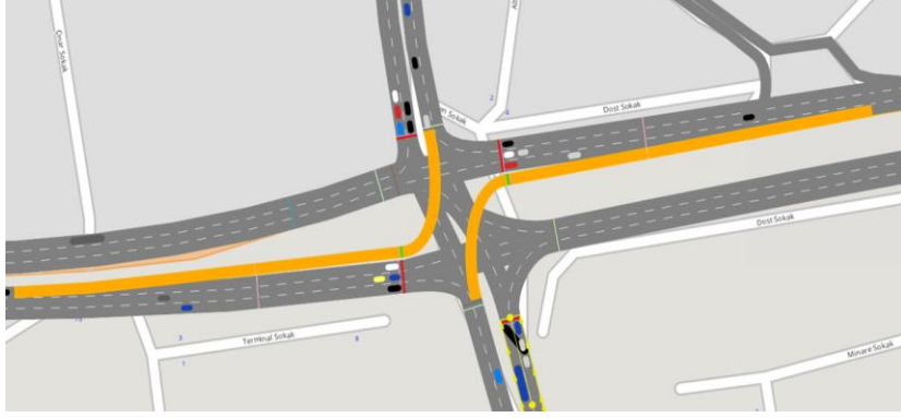
Şekil 2.24. Sola dönüş cepli sinyalizasyon kavşağına ait benzetim yazılımı görüntüsü
