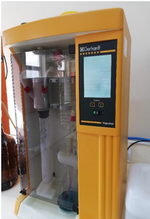
Şekil 2. Protein analizinde kullanılan distilasyon cihazı
