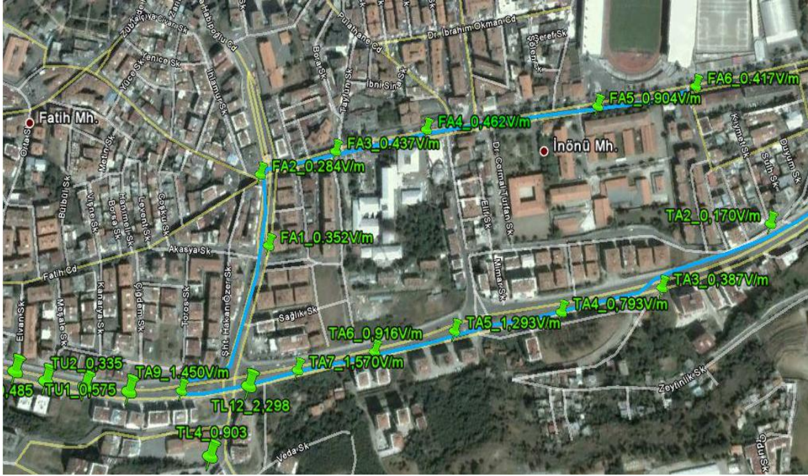
Ek Şekil 3. Yavuz Selim Bulvarı ve İnönü Caddesi boyunca GSM 900 MHZ bandında elde edilen ortalama elektrik alan şiddeti ölçüm değerlerinin harita üzerinde gösterimi
