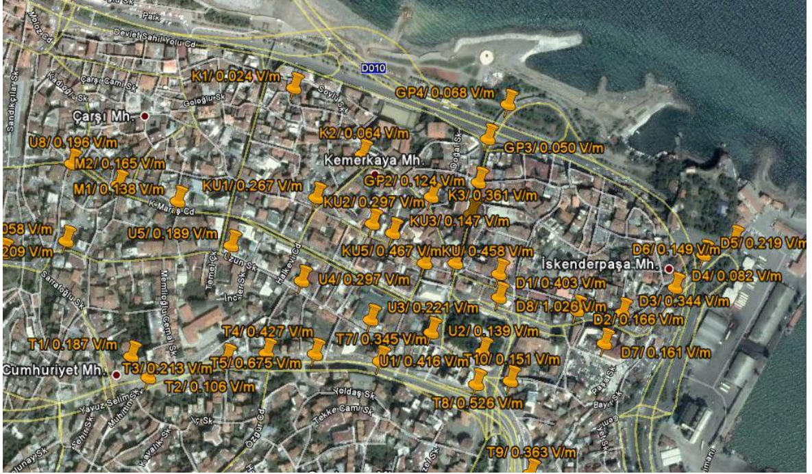
Ek Şekil 7. Tanjant ve Devlet Sahil Yolu arasında bulunan bölge civarında 2GHz bandında elde edilen ortalama elektrik alan şiddeti ölçüm değerlerinin harita üzerinde gösterimi
