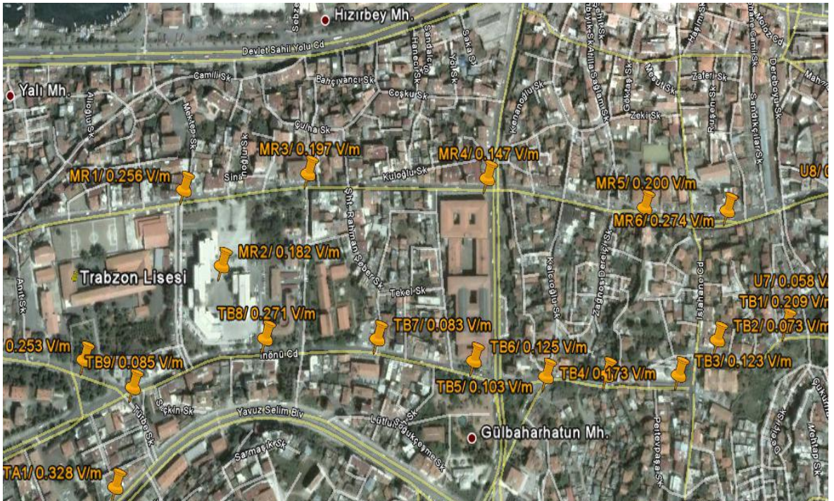
Ek Şekil 8. Maraş Caddesi ve İnönü Caddesi boyunca 2GHz bandında elde edilen ortalama elektrik alan şiddeti ölçüm değerlerinin harita üzerinde gösterimi
