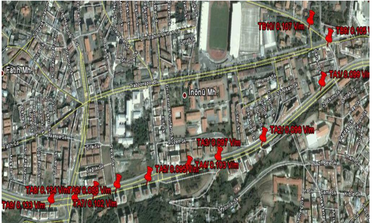
Ek Şekil 6. Yavuz Selim Bulvarı boyunca FM, VHF ve UHF bandında elde edilen ortalama elektrik alan şiddeti ölçüm değerlerinin harita üzerinde gösterimi
