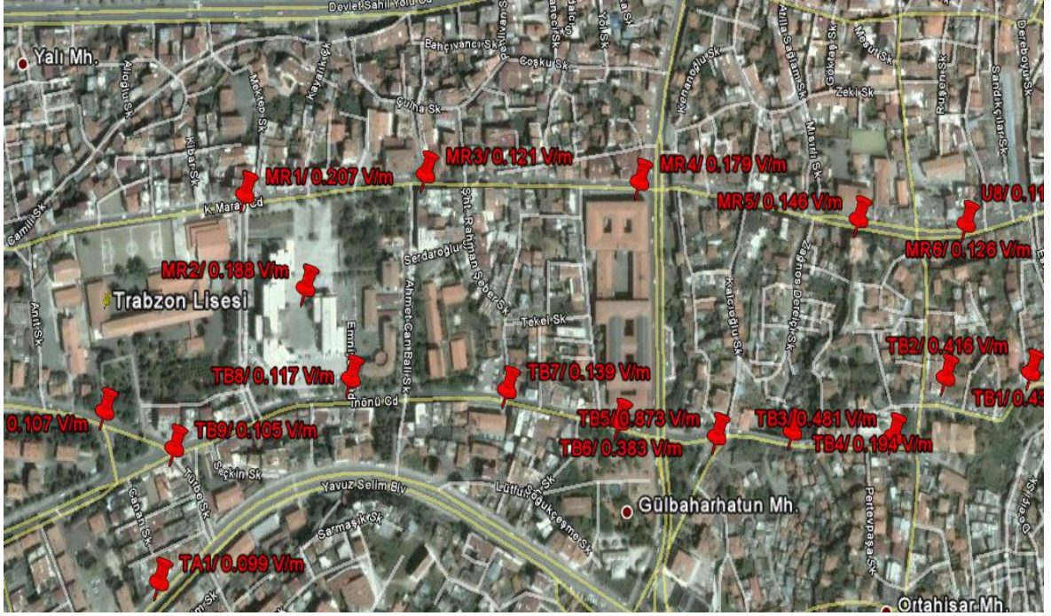
Ek Şekil 5. Maraş Caddesi ve İnönü Caddesi boyunca FM, VHF ve UHF bandında elde edilen ortalama elektrik alan şiddeti ölçüm değerlerinin harita üzerinde gösterimi
