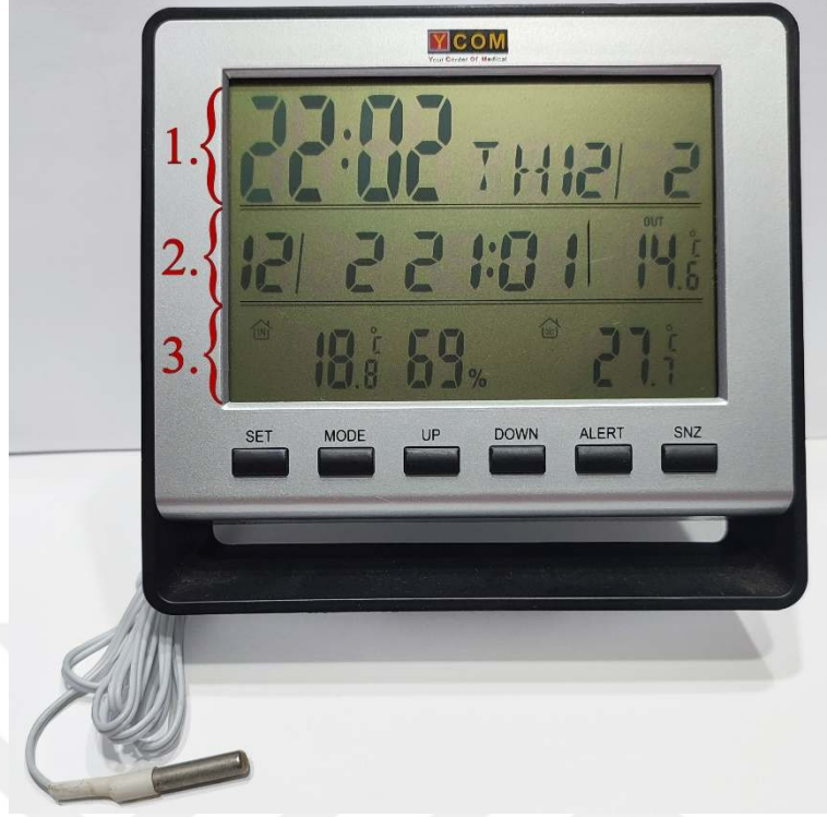
Şekil 19. İç/dış ısı ve nem ölçüm cihazı YCOM – KMN 305
