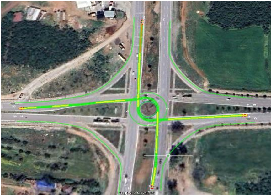
Şekil 4.46. Kavşağın Torus yazılımında çizilmiş geometrik tasarımı
