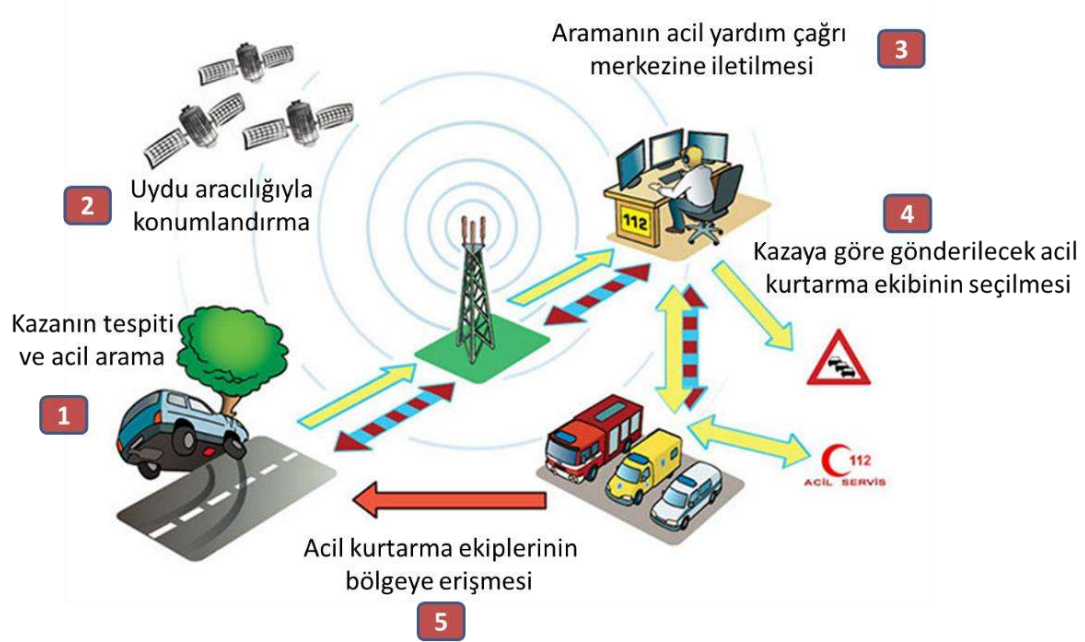
Şekil 2. 7 eCall projesi kapsamında olay tespiti süreci
