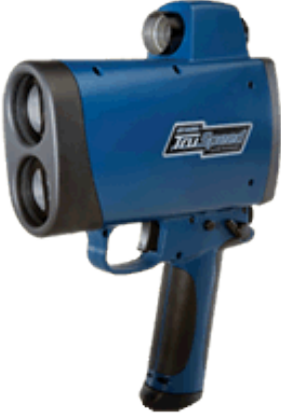
Şekil 3.1. Çalışmada kullanılan TruSpeed/Dc Lazer hız tabancası
