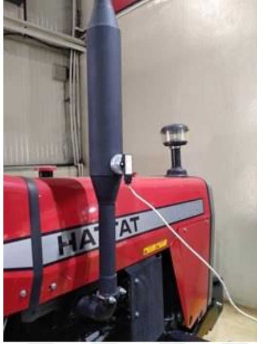
Şekil 3.17. Egzoz Üzerine Yerleştirilen İvmeölçer Görüntüsü
