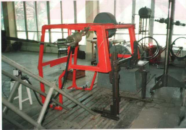
Şekil A.6. Yandan Yatay Yönde Yükleme Deney Düzeni
