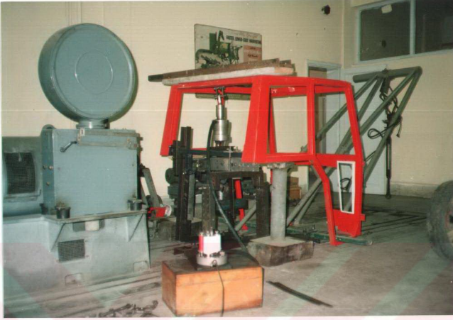
Şekil A.5. Üstten Arka Taraftan Düşey Yönde Sıkıştırma Deney Düzeni
