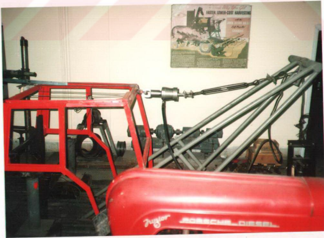
Şekil A.4. Arkadan Öne Doğru Yatay Yönde Yükleme Deney Düzeni
