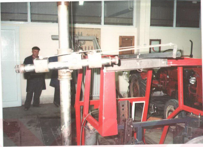
Şekil A.3. Kuvvetin Tatbik Noktasının Hareket Miktarını Ölçme Düzeni
