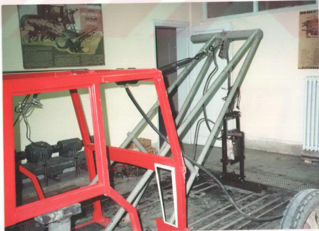
Şekil A.2. Yatay Yükleme Deneyinde Kullanılan Kuvvet Uygulama Düzeni
