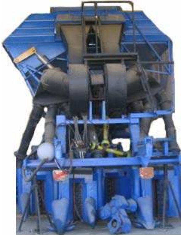
Şekil 6. Traktöre montajı yapılmamış pamuk hasat makinası
