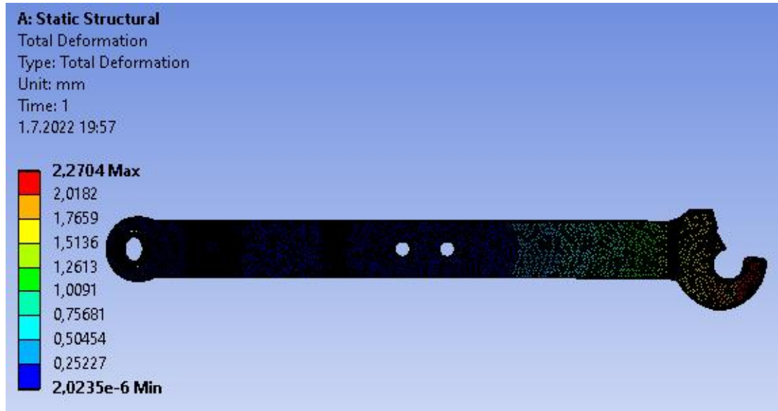
Şekil 4.12. Alt konum durumunda 42CrMo4 malzemede oluşan toplam deformasyon gradyanı
