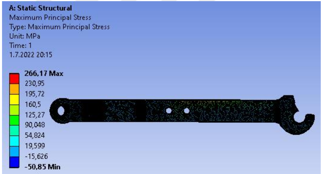
Şekil 4.27. Üst konum durumunda 42CrMo4 malzemede oluşan asal gerilme gradyanı
