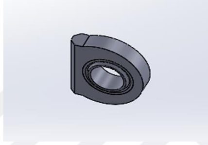
Şekil 3.9. Alt kaldırma koluna ait traktör bağlantı yatağının üç boyutlu modeli
