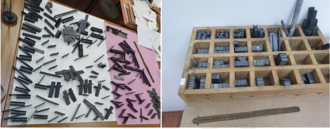
Görsel 4.12. Temizliğin ardından hurufat kasasının üzerine yerleştirilen anterlinler ve boş malzemeler. Kaynak: Konur Koldaş Fotoğraf Arşivi (Erişim Tarihi: 20.06.2022)
