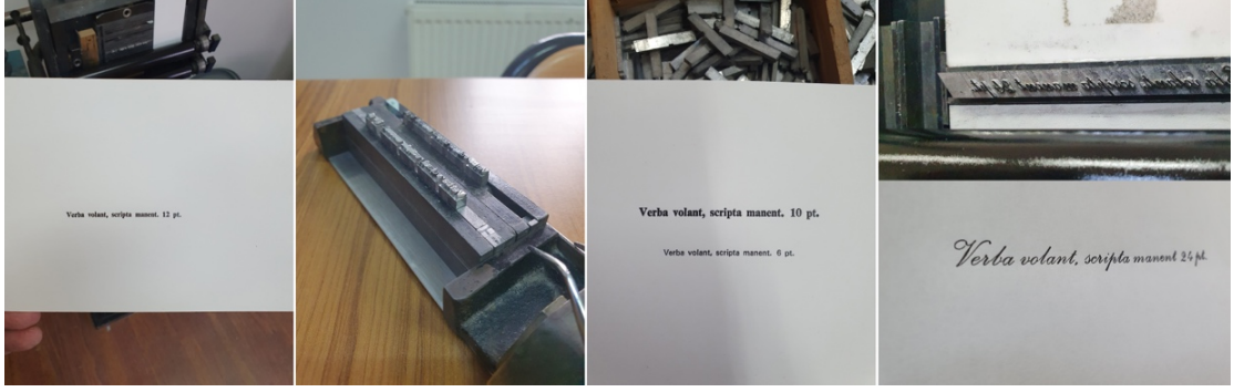
Görsel 4.14. Hurufat kasası tanımlayıcı etiketlerin basım aşamaları. Kaynak: Konur Koldaş Fotoğraf Arşivi (Erişim Tarihi: 20.06.2022)
