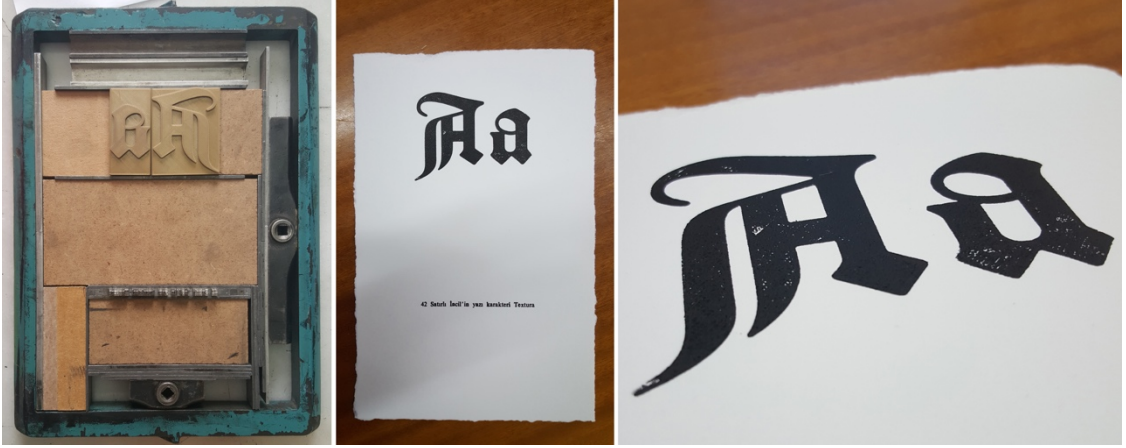
Görsel 2.7. 3B yazıcı ile basılan Gutenberg İncili'nin yazı karakteri Textura'nın majiskül ve miniskül 'A, a' harfleri ve tipo baskı sonuçları. Kaynak: Konur Koldaş görsel arşivi, 2016.
