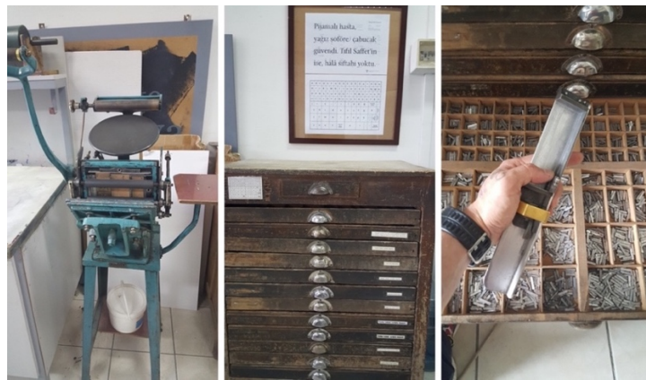
Görsel 3.17. Anadolu Üniversitesi Güzel Sanatlar Fakültesi Grafik Sanatlar Bölümü'deki elpedallı tipo baskı makinesi ve hurufat kasası. Kaynak: Konur Koldaş Fotoğraf Arşivi (Erişim Tarihi: 23.06.2022)
