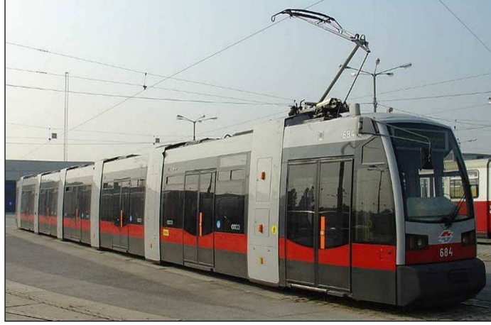
Şekil 3.19 : Ultra Düşük Tabanlı Tramvay –Viyana.
