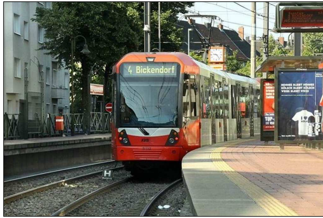
Şekil 3.17 : Yüksek tabanlı tramvay ve yüksek peron.
