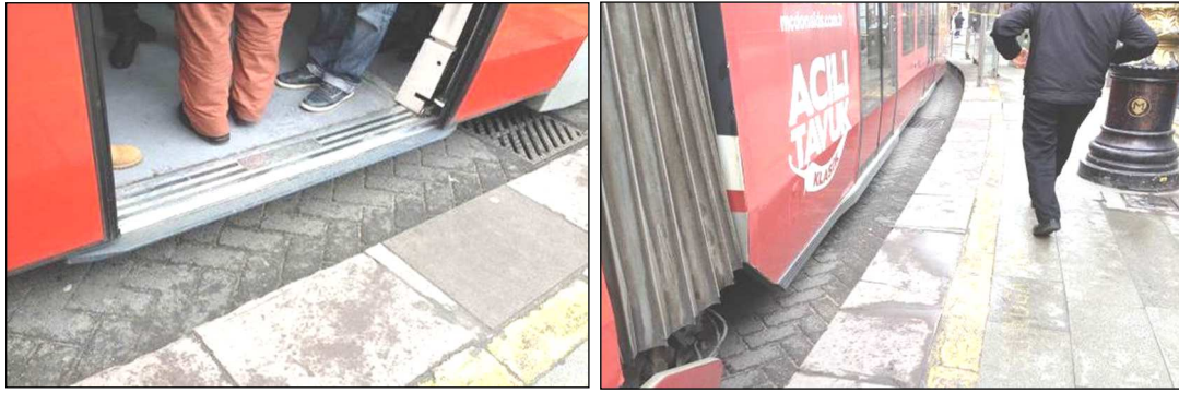
Şekil 4.10 : Kurpta Yer Alan Gülhane İstasyonu – Peron ve Araç Arası Boşluk
