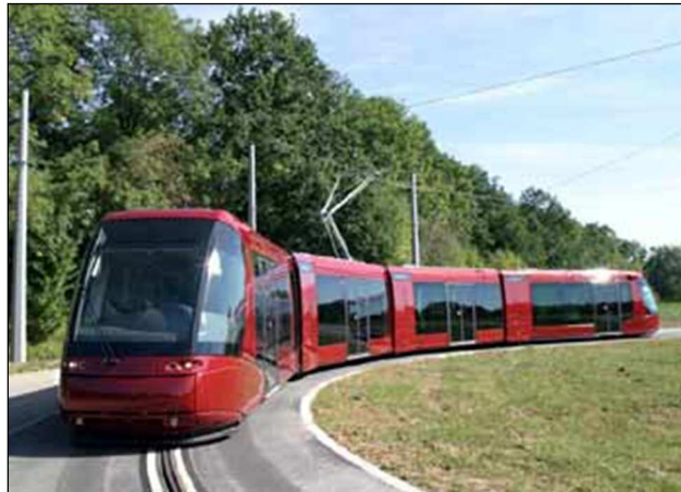
Şekil 2.2 : Lastik Tekerlekli Tramvay
