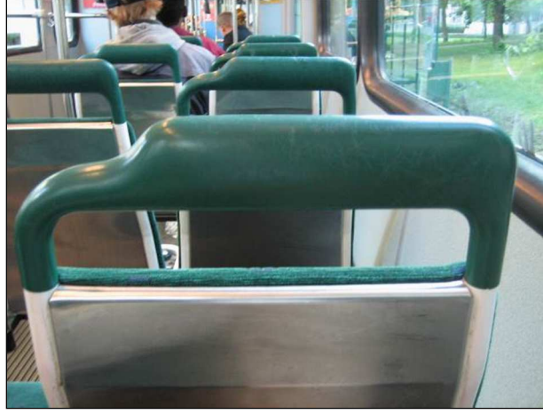
Şekil 3.38 : Yanmaz esnek ve darbe emici koltuk başlığı
