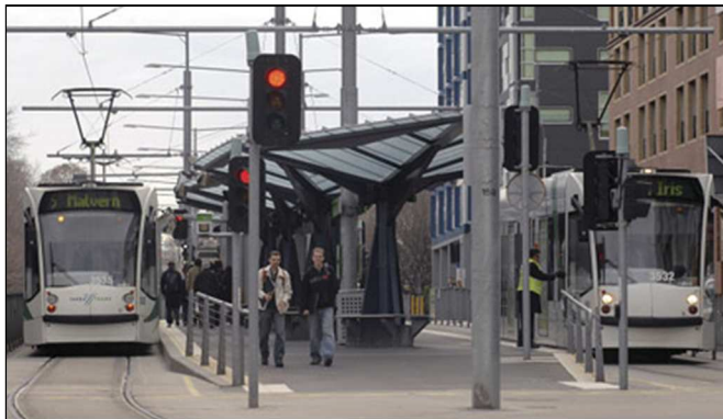
Şekil 3.18 : Alçak tabanlı tramvay – alçak peron (Victoria).
