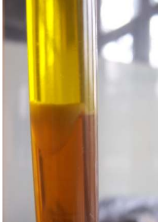
Resim 3.10. Santrifüjlenen gliserin ester karışımı
