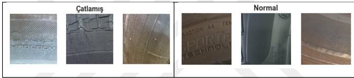
Şekil 3.2. Örnek lastik görüntüleri, a) Çatlamış ve b) Normal
