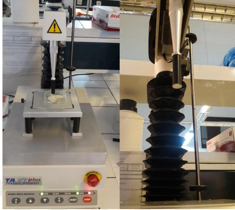
Resim 1. Texture cihazı ile PLGA nanopartiküllerin biyoadezyon ölçümü.
