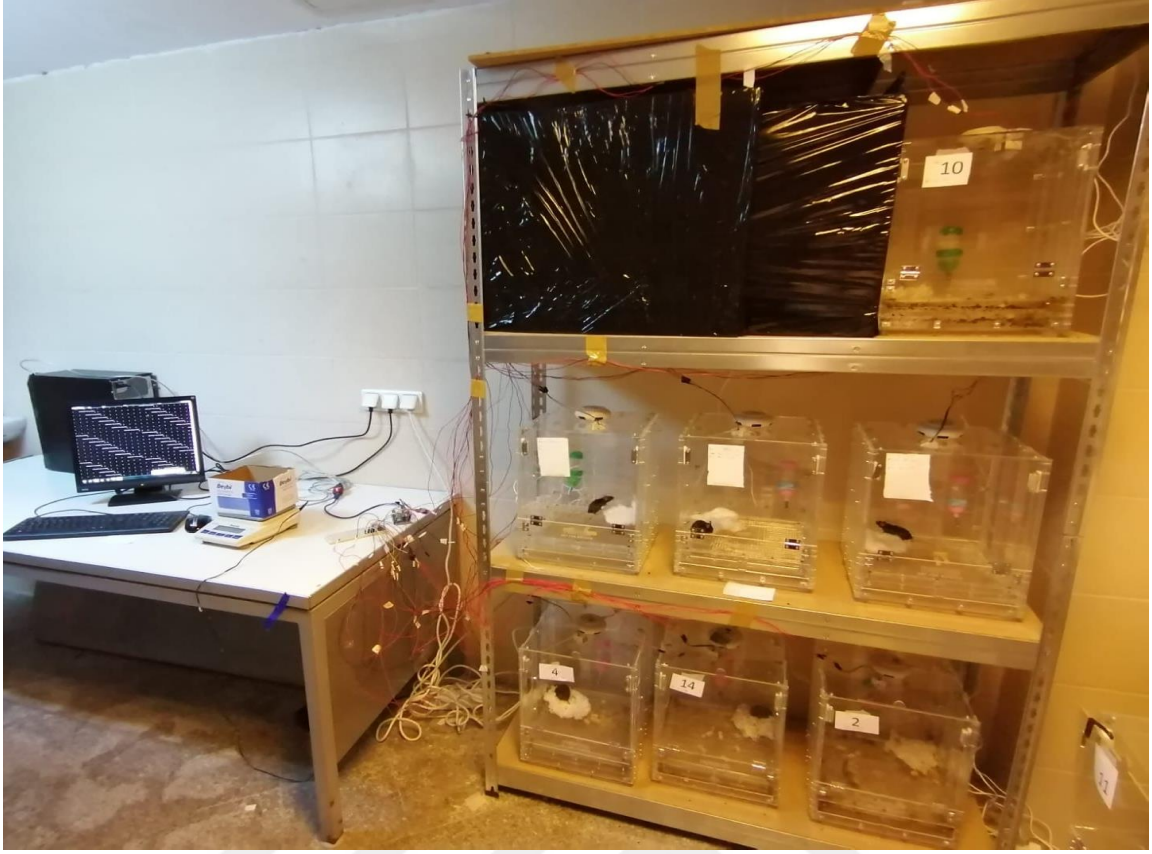
Şekil 3.5. Lokomotor ve beslenme davranışlarının takip edildiği davranış kafes sistemleri
