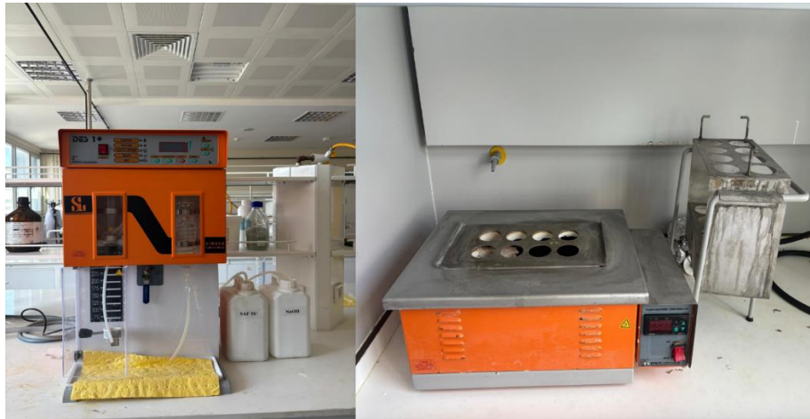
Resim 3.3. Protein tayini için kullanılan distilasyon ve yakma ünitesi
