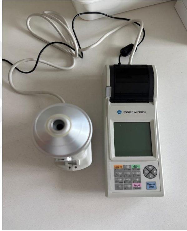
Resim 3.4. Renk analizi için kullanılan kolorimetre
