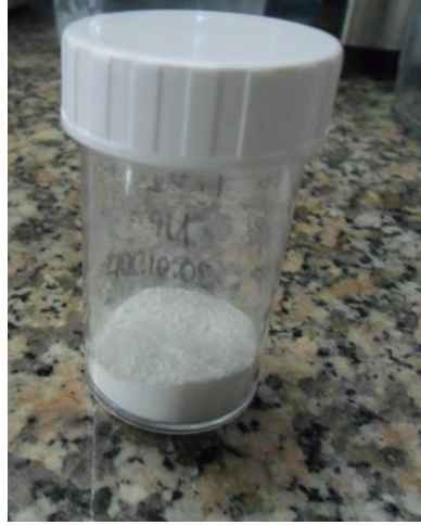
Şekil 7. 3 Elde edilen TiO 2 nanoparçacıkların kalsine sonrası toz görüntüsü
