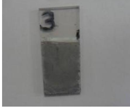
Şekil 8. 29 Manyetik alan kullanılarak 3dk kaplanan ITO cam
