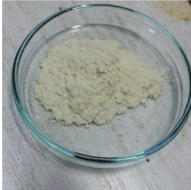
Şekil 8. 24 Üretilen kükürt katkı \text{TiO}_2 nanotozlar
