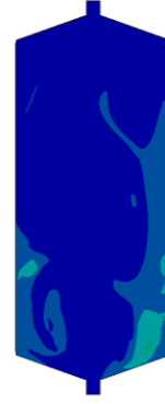
Şekil 6.42 M1 kollektör 800 W/m 2 için akış debilerine göre havanın sıcaklık profilleri
