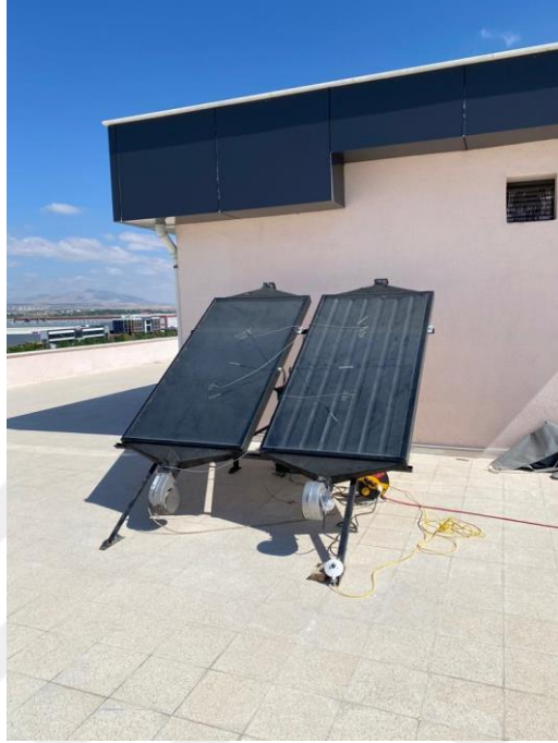
Şekil 5.6 Deneyler için hazırlanan M1 ve M2 model kollektörler
