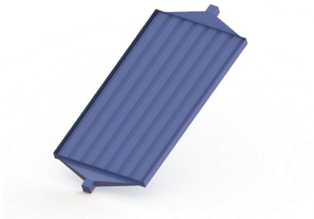
Şekil 5.15 Havalı kollektör akış hacmi
