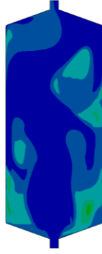
Şekil 6.42 M1 kollektör 800 W/m 2 için akış debilerine göre havanın sıcaklık profilleri
