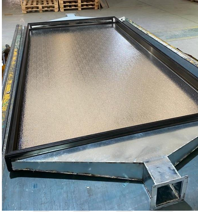
Şekil 5.2 Kollektör alüminyum kasası ve taban sacı
