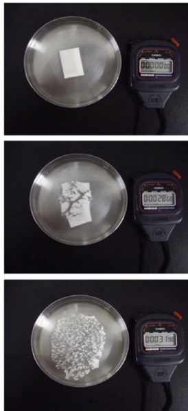
Şekil 2.9. Petri kabı yöntemi ile OHÇF'in parçalanma testi (Takeuchi vd., 2018)
