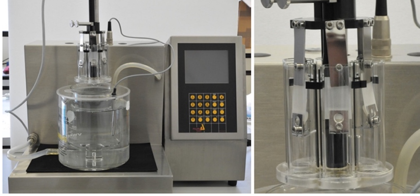
Şekil 2.10. OHÇF'ler için bir numune tutucu ile donatılmış PharmaTest® parçalanma test cihazı (Speer vd., 2018)
