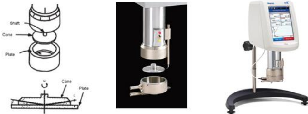
Şekil 4.22. Brookfield DV2T RCVP model viskozite ölçüm cihazı
