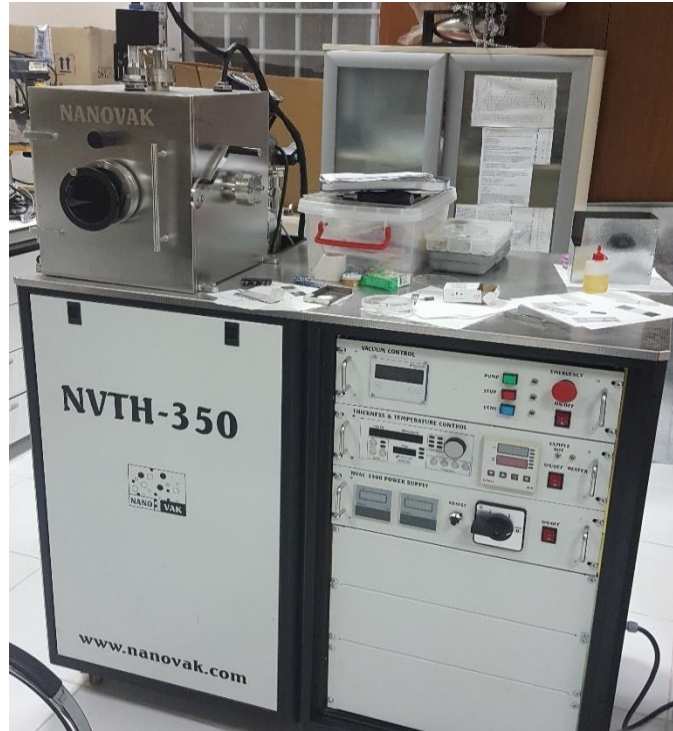
Şekil 3.3. Nanovak NVTH-350 termal buharlaştırma sistemi
