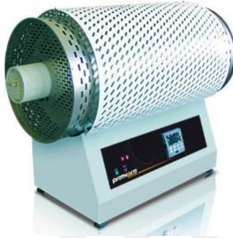
Şekil 3.2. 0-1200 °C ayarlı Protherm PTF 12/75/800 tüp fırın
