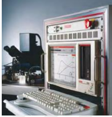
Şekil 3.4. Keithley 4200 SCS yarıiletken karakterizasyon cihazı
