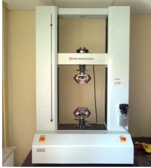
Şekil 4.8. Deneylerde kullanılan çekme cihazı
