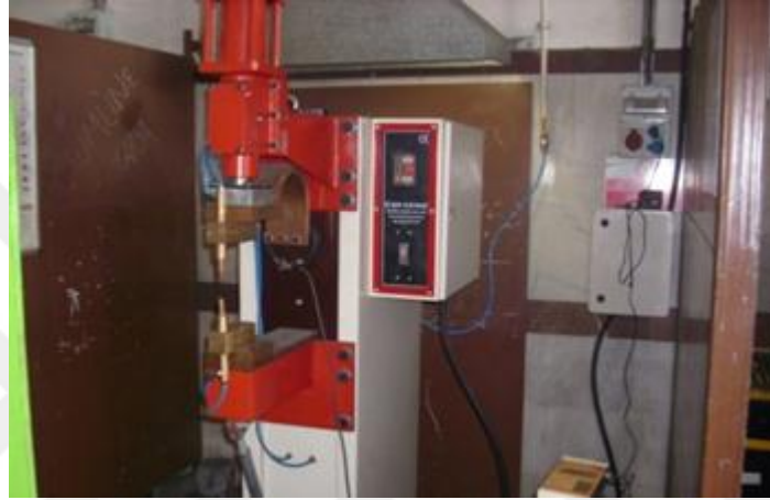
Şekil 4.3. Deneylerde kullanılan elektrik direnç nokta kaynağı makinesi
