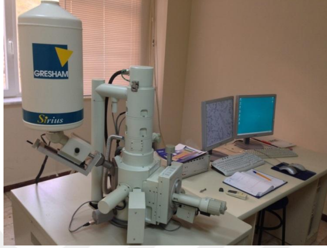
Şekil 4.10. Mikroyapı incelemelerinde kullanılan taramalı elektron mikroskobu (SEM)
