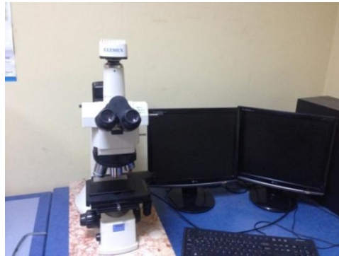
Şekil 4.9. Mikroyapı incelemelerinde kullanılan optik mikroskop
