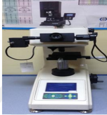
Şekil 4.12. Sertlik ölçümlerinde kullanılan mikrovickers sertlik ölçme cihazı
