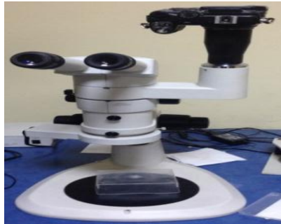
Şekil 4.11. Makroyapı incelemelerinde kullanılan optik mikroskop
