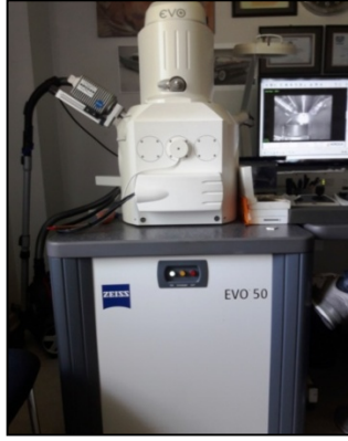
Şekil 7.16. Analiz için kullanılan taramalı elektron mikroskobu
