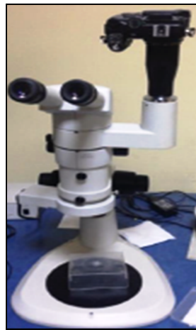
Şekil 7.14. Çekirdek boyutu ölçümünde kullanılan optik mikroskop
