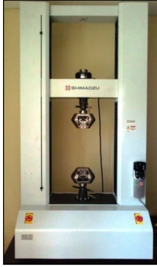
Şekil 7.13. Deneylerde kullanılan 5 tonluk çekme – basma cihazı
