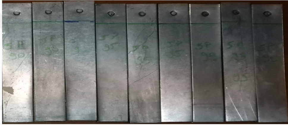
Şekil 7.10. Çekme – Sıyırma deney numuneleri
