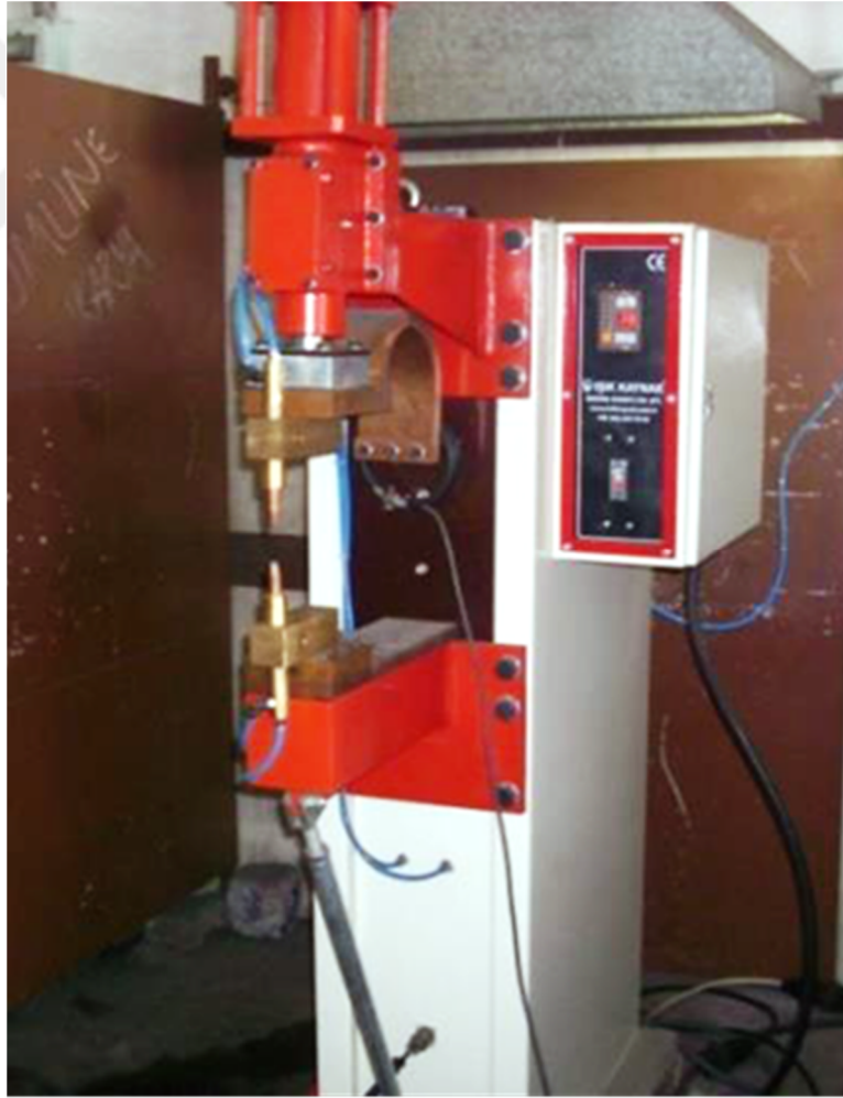
řekil 7.4. Elektrik direnç nokta kaynak makinesi
