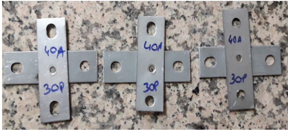
Şekil 7.11. Çapraz çekme deney numuneleri
