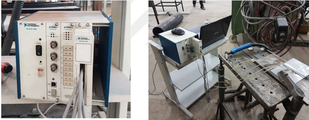
Şekil 4.9. Çalışmada yararlanılan 8 kanallı National instruments NI SCXI 1000 data logger girişli bilgisayar düzeneği
