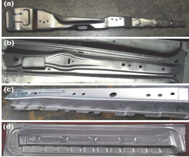
Şekil 2.11. Q&P 980 kodlu TRIP çeliğinden üretilen B sütunu destekleri, eşikler ve tampon destekleri örnekleri [36]
