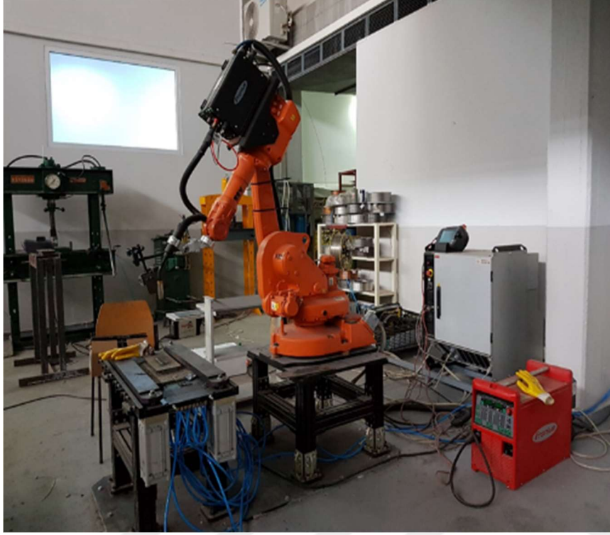
Şekil 4.7. GMAK yönteminde kullanılan entegre robotik kaynak düzeneği tel besleme ve kontrol ünitesi
