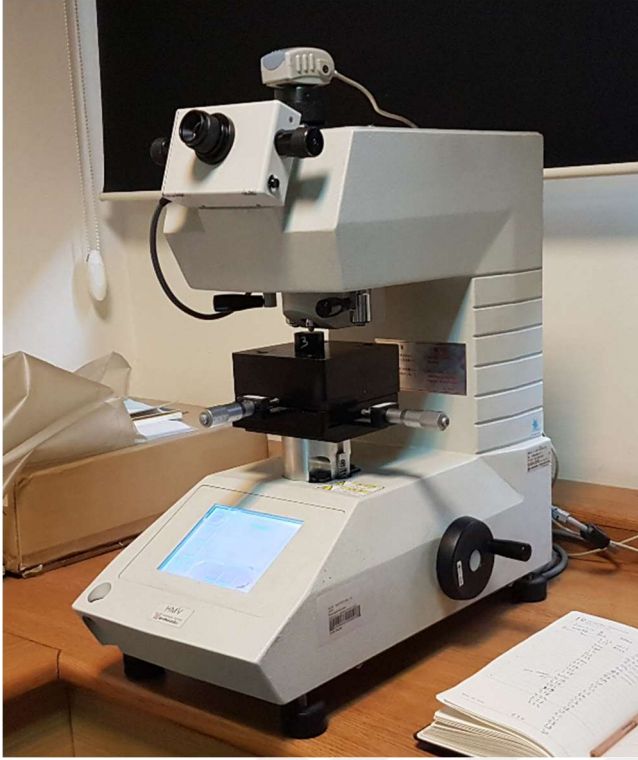
Şekil 4.11. Sertlik ölçümünün yapıldığı Shimadzu HSV-20 marka Vickers mikrosertlik cihazı
