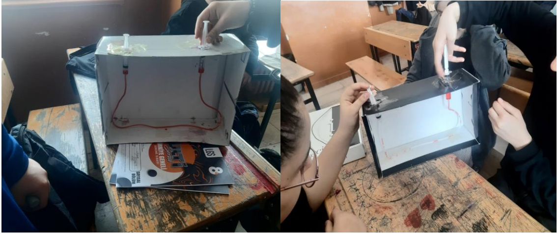
Şekil 2.1 Pascal Prensibi ile Yapılan Asansör
