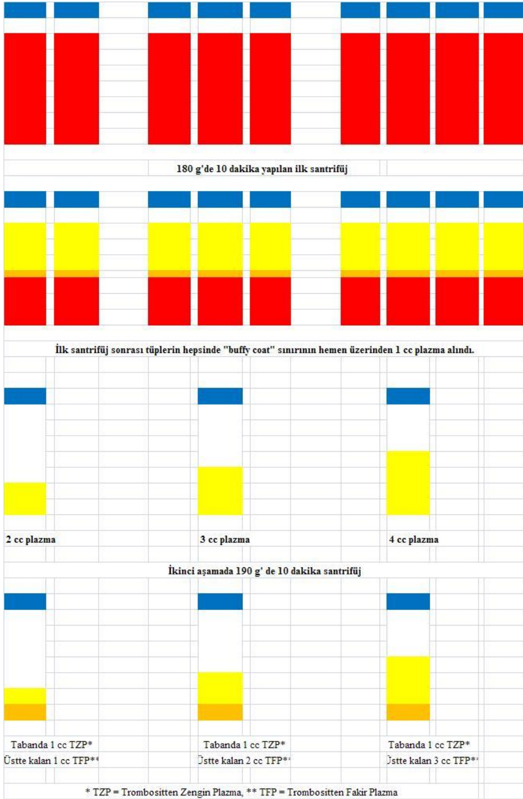
Şekil-3: TYP hazırlanmasını gösteren şema
