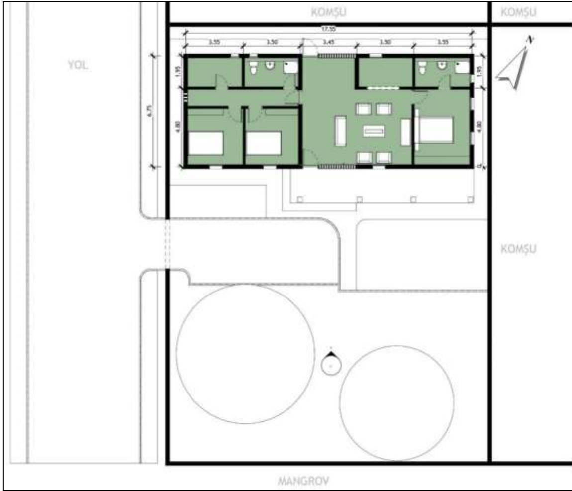
Şekil 4.4. Birinci aşamanın zemin kat planı
