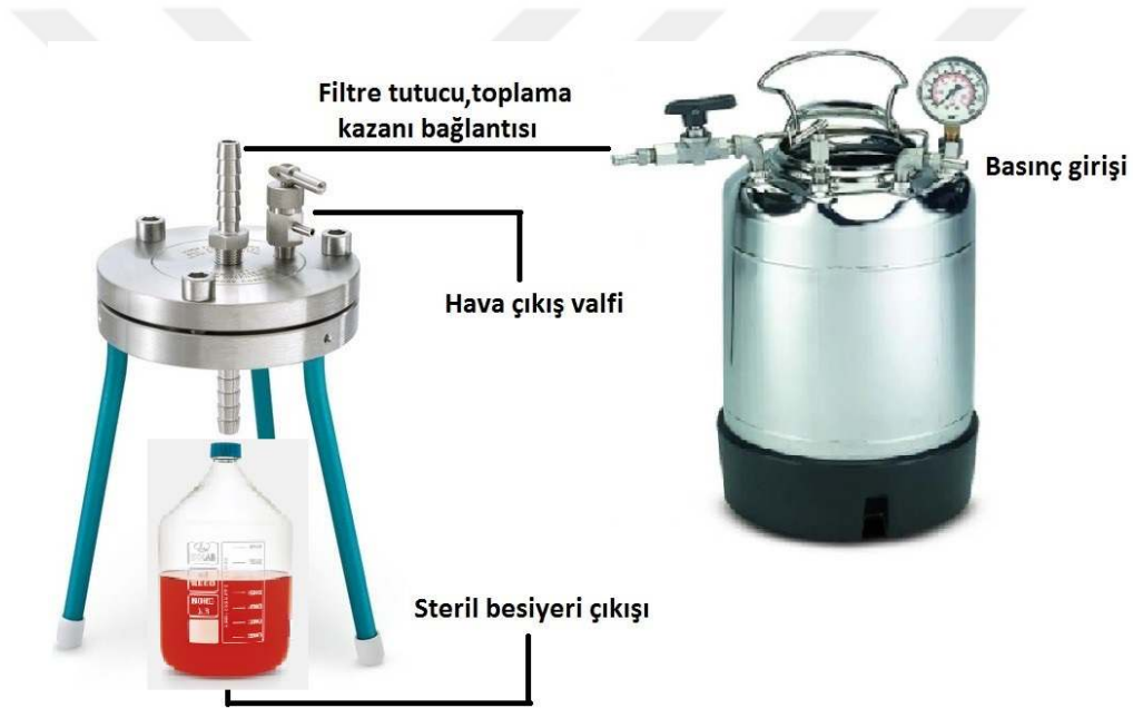
Şekil 10. Basınçlı filtrasyon sistemi ile besiyeri sterilizasyonu
