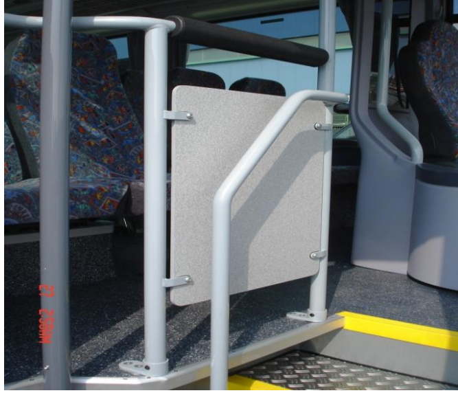
Şekil 2.1. Ayırma duvarı (Foto Solak).
