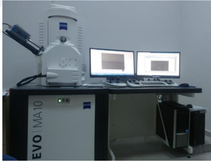
Şekil 7.9 Numunelerin SEM ve EDX analizlerinin yapıldığı Zeiss EVO MA10 marka SEM cihazı
