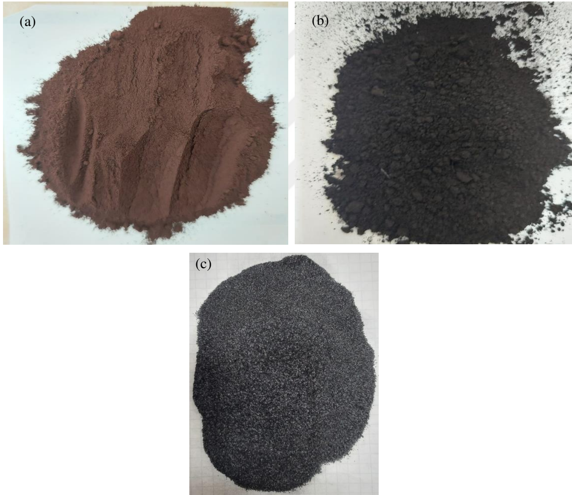
Şekil 7.1 Deneylerde Kullanılan hammaddeler (a)Hematit Cevheri (b) Soma Bölgesi Linyit Kömürü, (c)Tufal Atığı
