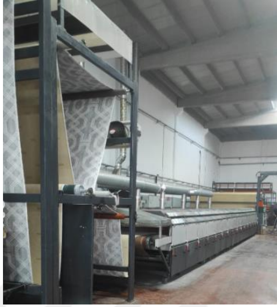
Şekil 3.13. Tufting Sonrası Bitim Prosesi
