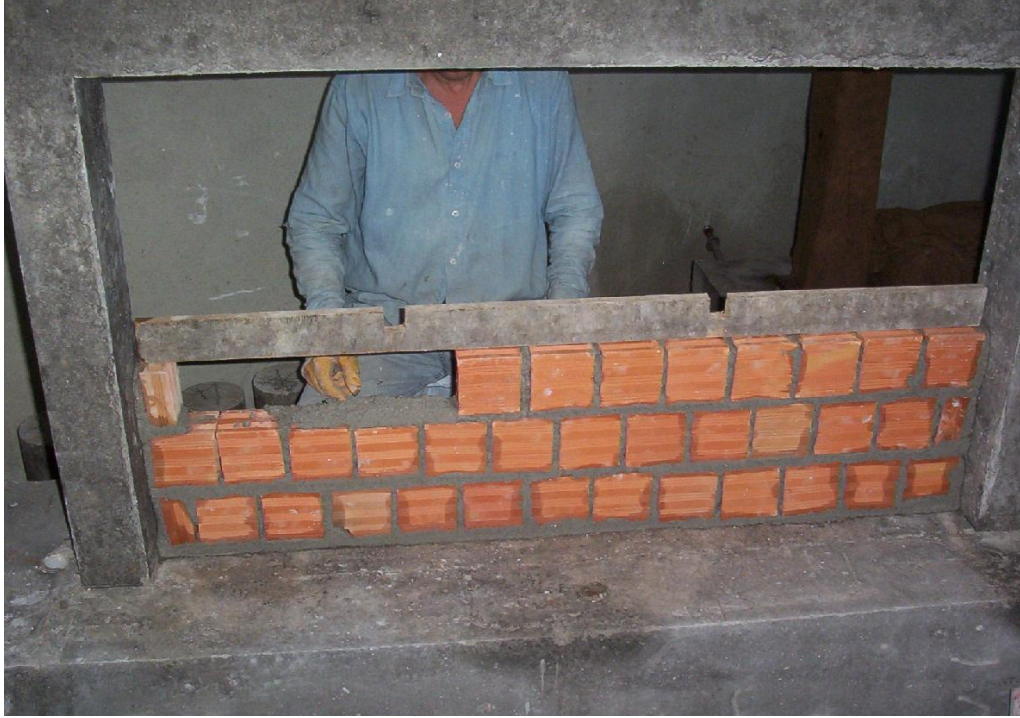
Resim 3.5. Test çerçevesi içine tuđla dolgu duvar örülmesi.
