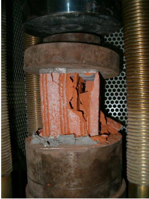
Resim 3.1. Tuğla birime basınç testi uygulanışı
