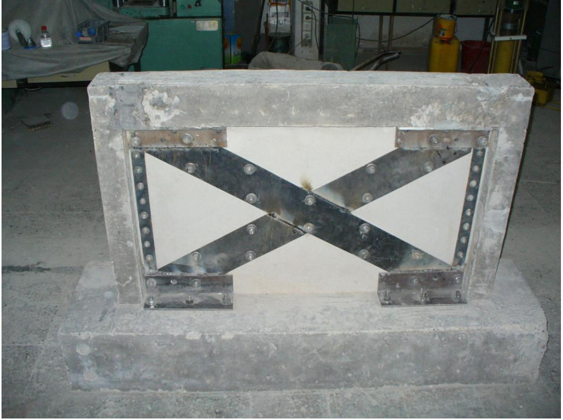
Resim 3.10. Çelik elemanların bağlantısı tamamlanmış olan Deney Elemanı-5'e ait görünüm.
