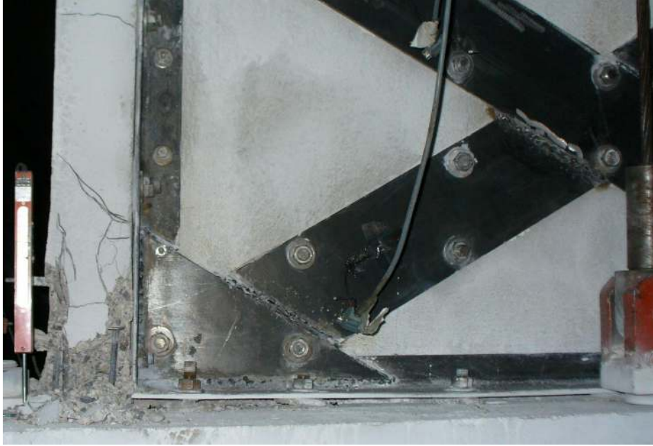
Resim 4.20. 15. ileri yük çevrimi sonunda sol kolon alt uç detayı
