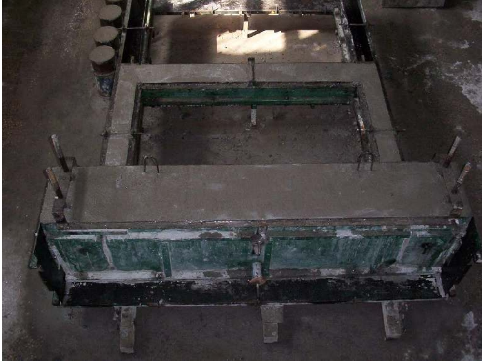
Resim 3.4. Dökümü tamamlanmış test çerçevesi
