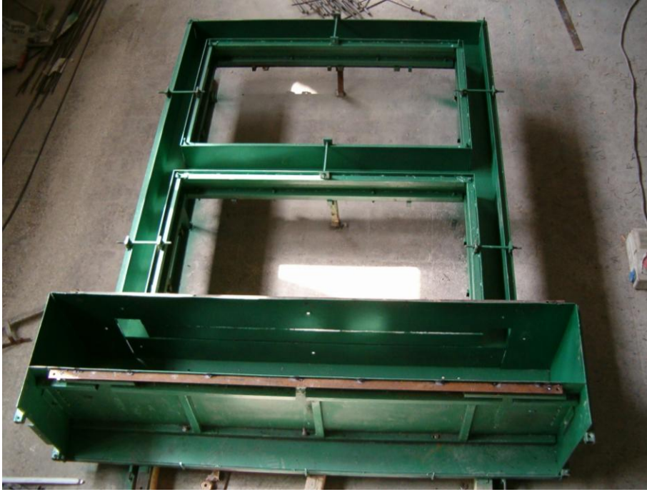
Resim 3.2. Çelik kalıbın laboratuvar ortamında görünüşü
