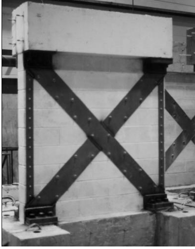
Resim 6.1. Düşey ve çapraz doğrultudaki çelik şeritlerle güçlendirilen duvar elemanı [17]
