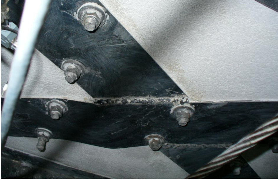
Resim 4.16. 19. çevrim sonrası burkulma detayı.
