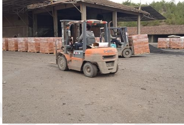
Şekil 4.2 Forkliftlerin tuğlaları taşıması
