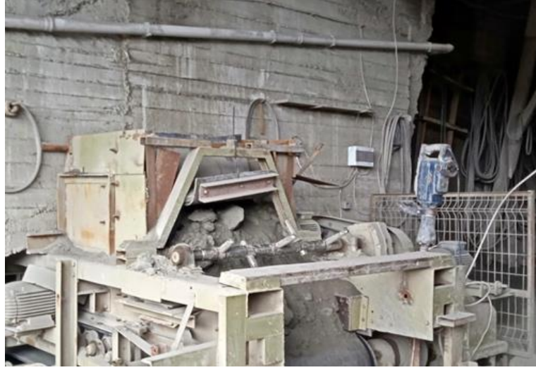
Şekil 4.12 Ham toprağın işletmeye ilk girişi ve tezek kırıcı
