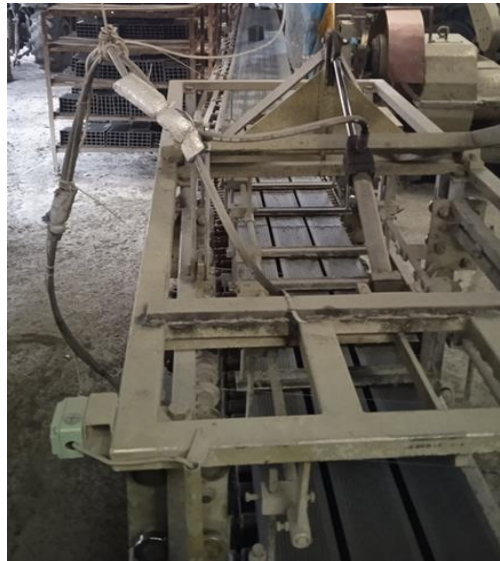
Şekil 4.21 Vakum-press makinasından sonsuz uzunlukta çıkan ürünler
