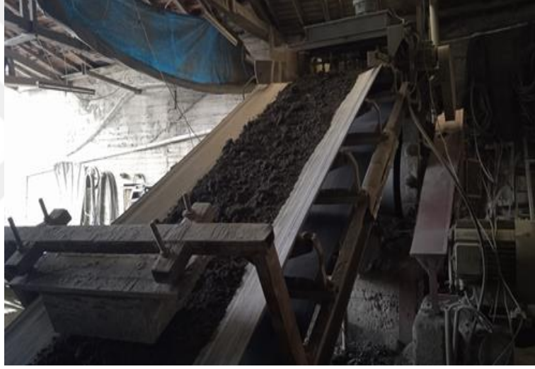
Şekil 4.16 Karıştırıcıya ilerleyen nemli toprak
