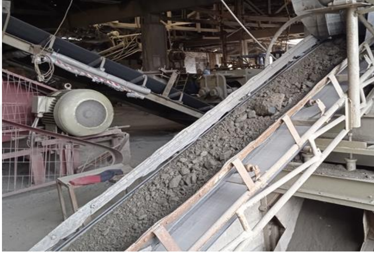
Şekil 4.13 Hareketli bant üzerinde ilerleyen ham toprak
