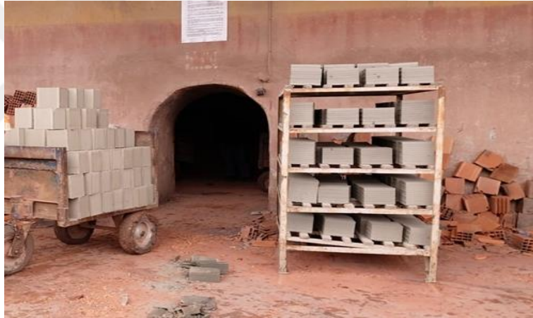
Şekil 4.26 Fırın içerisine istiflenmeyi bekleyen tuğla formundaki kuru çamur
