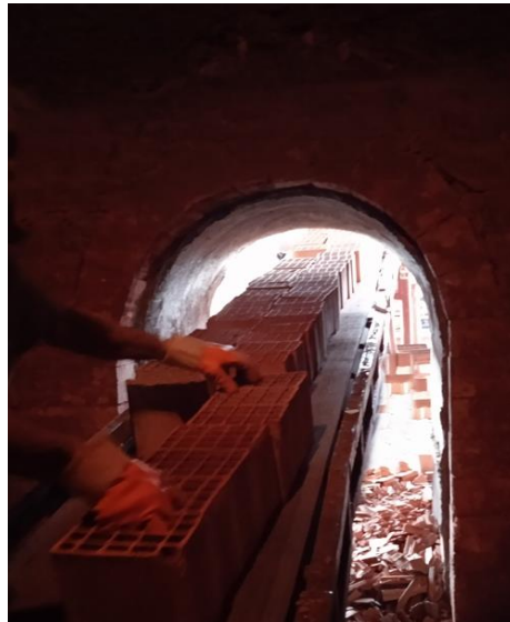
Şekil 4.30 Pişmiş tuğlanın fırın içerisinden çıkartılması
