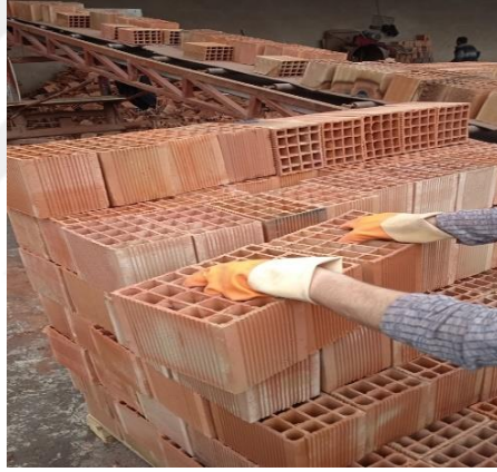
Şekil 4.34 İnsan gücü ile tuğla istifleme
