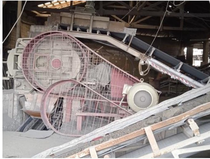
Şekil 4.1 Taşıyıcı bant ile muhafaza altındaki kayış kasnak mekanizması
