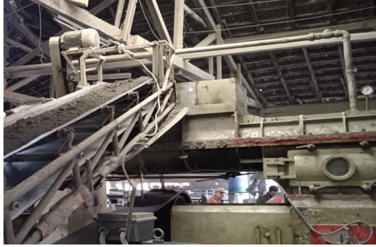
Şekil 4.19 Nemli toprağın vakum-press makinasına ilerlemesi
