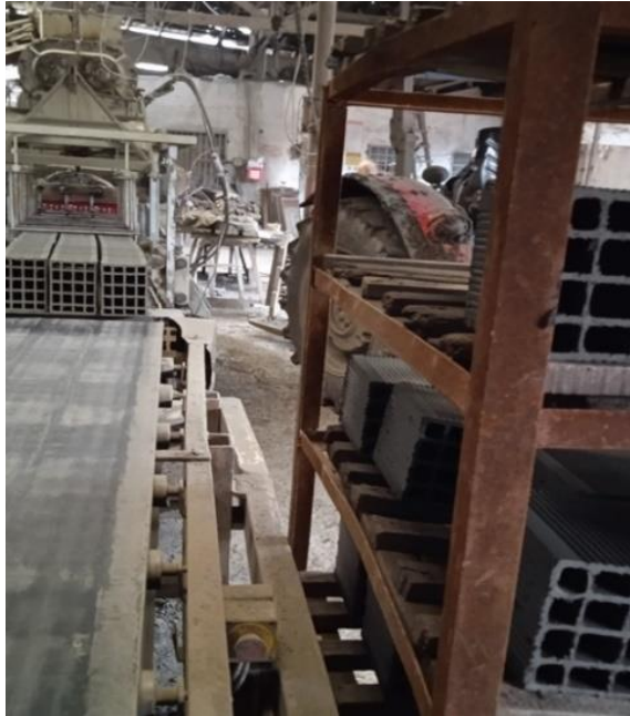
Şekil 4.23 Tuğla formundaki çamurun kurutma tezgâhlarına alınması
