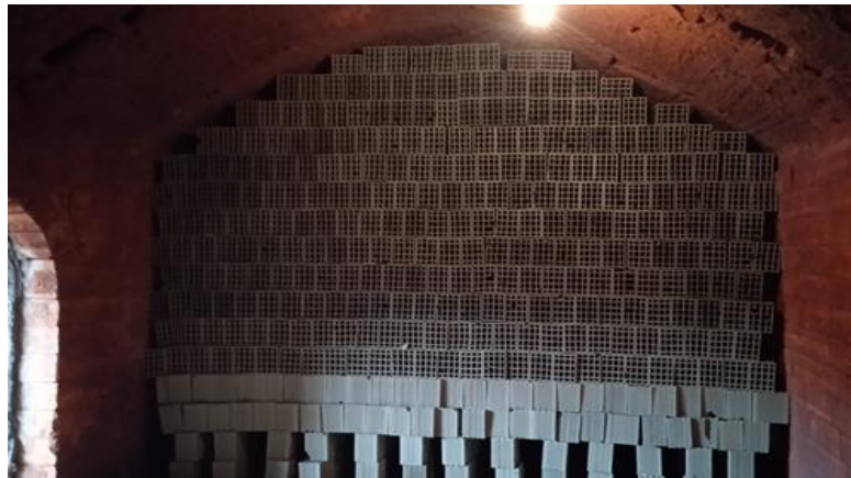
Şekil 4.27 Hoffman tipi fırın içerisine istiflenmiş olan ürünler
