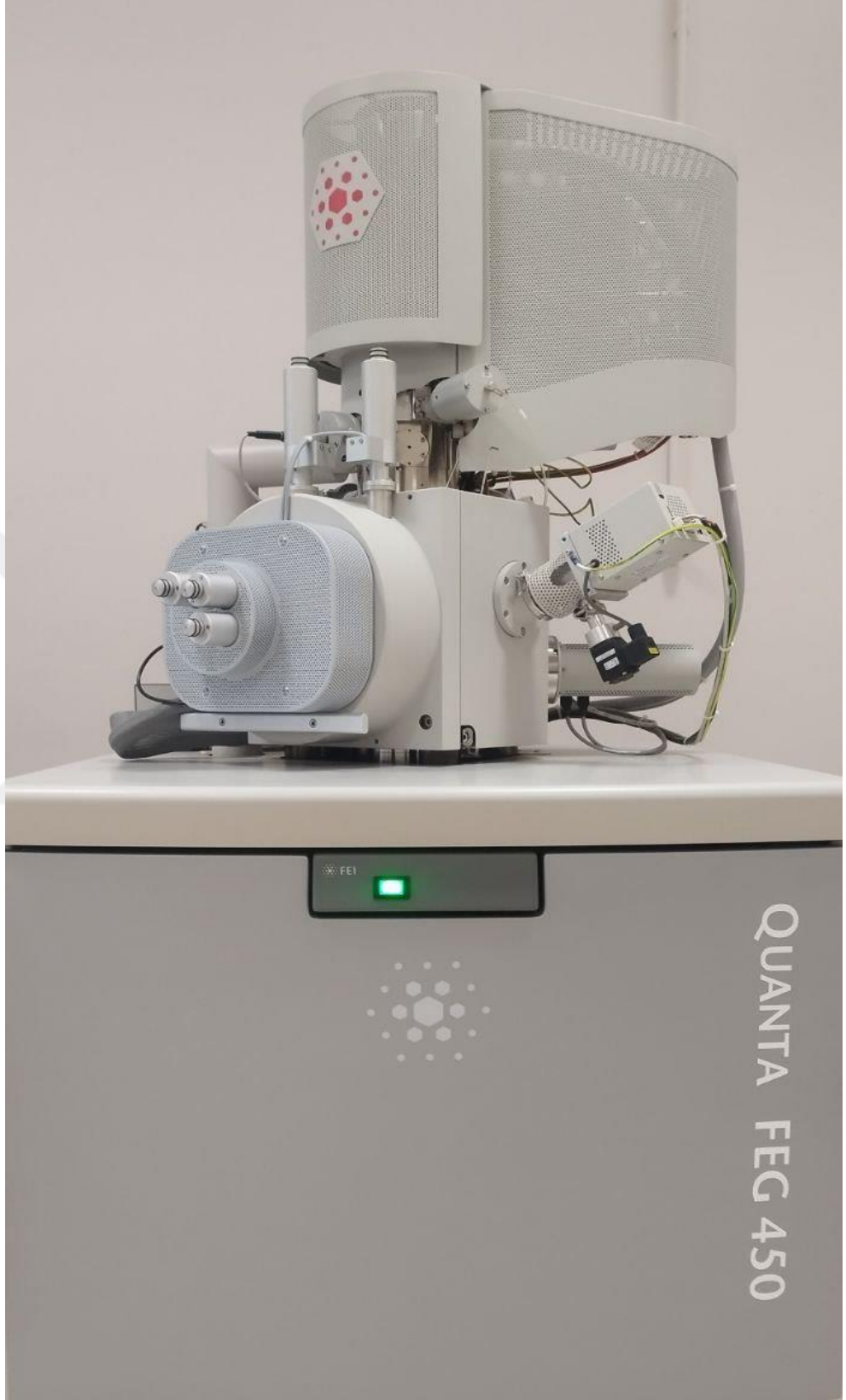
Şekil 4.16. Quanta 450 taramalı elektron spektrometresi (SEM) FEI Quanta FEG 450 SEM’de:
