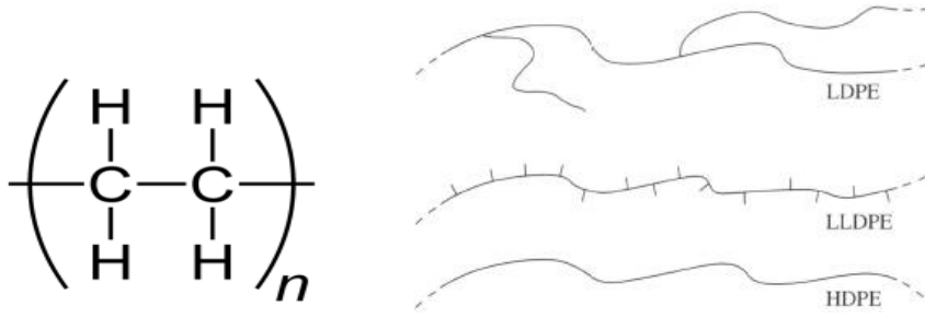
Şekil.2.3.1. Polietilen molekülü ve dallanma yapısı
