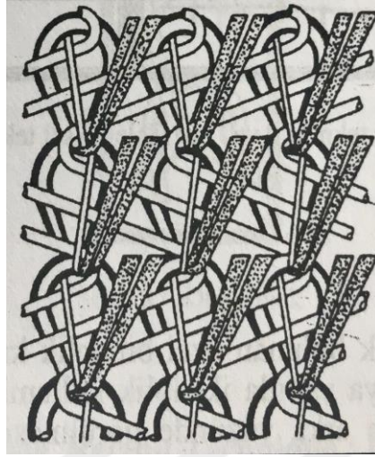
Resim 61: Çözü örne pelüş kumaşın şematik görünümü (Marmaralı, Kretzschmar, 2004: 100)
