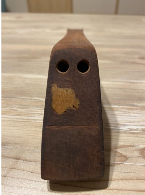
Görsel 67: Ses Dalgalanmasının Önüne Geçilmesi İçin Açılan 8 mm'lik Delikler
