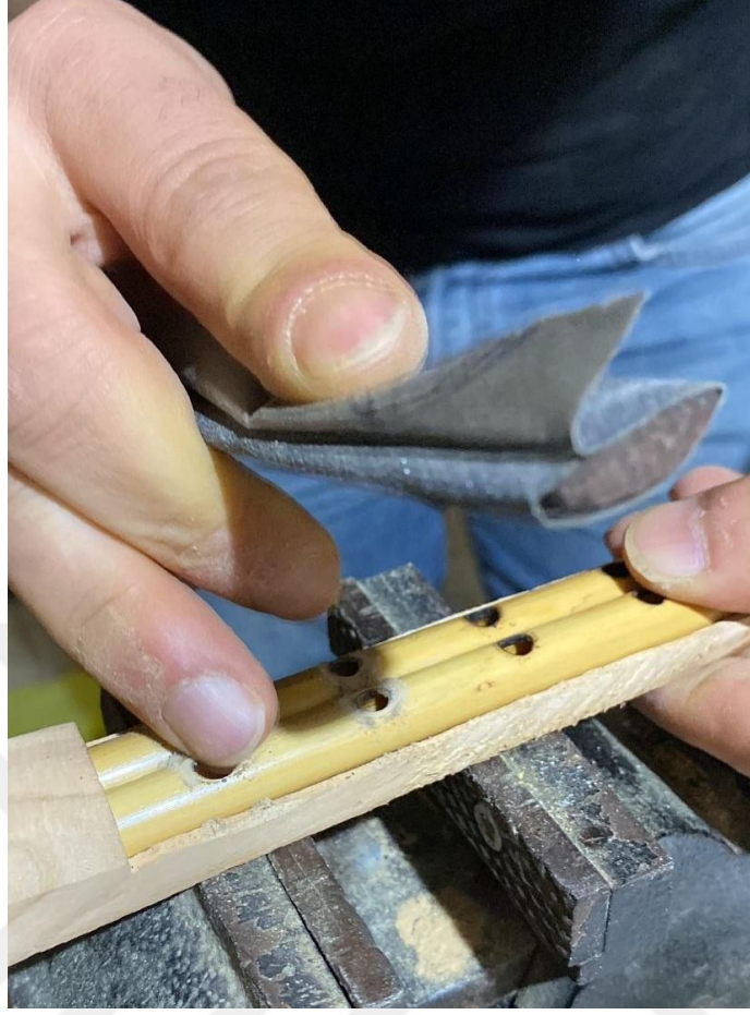
Görsel 49: Perdelerin Üzerindeki Çapakların Temizlenmesi
