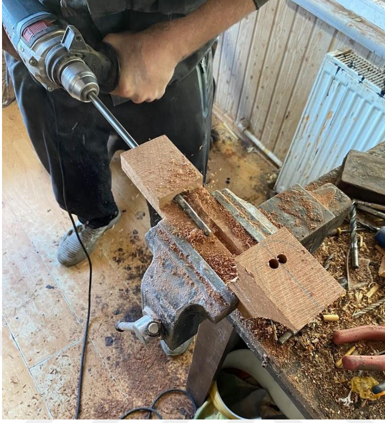
Görsel 41: Silindir Matkap ile Analık Yuvasının Açılması
