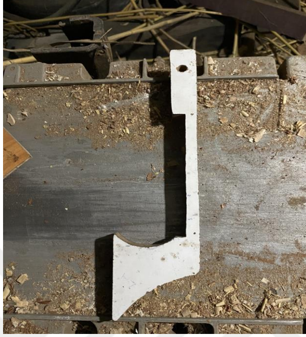
Görsel 35: Markalama İşlemi İçin Kullanılan La Karar Nav Kalıbı
