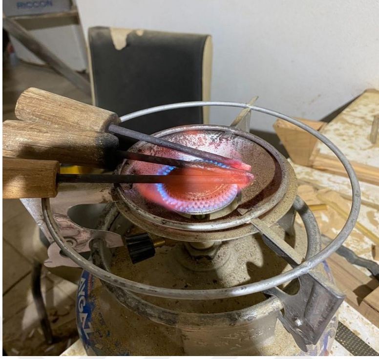
Görsel 47: Delikleri Açmak İçin Isıtılan Tornavida Uçları
