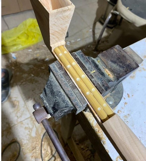
Görsel 46: Perde Deliklerinin Kamışlar Üzerinde Belirlenmesi
