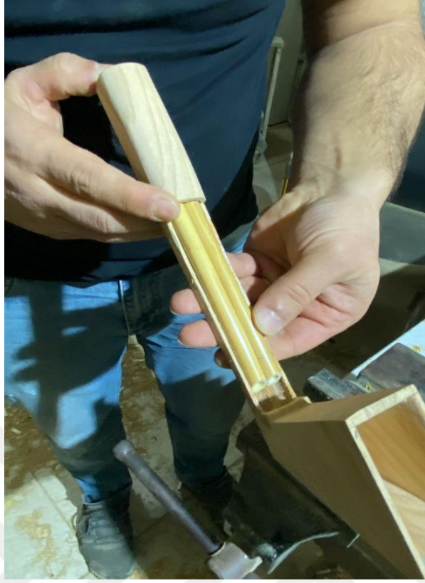
Görsel 45: Analık Kamışlarının Yapıştırılarak Navın İçerisine Yerleştirilmesi
