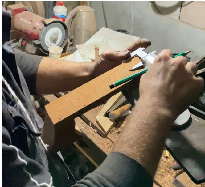
Görsel 38: Oyulacak Dillik Bölümünün İşaretlenmesi
