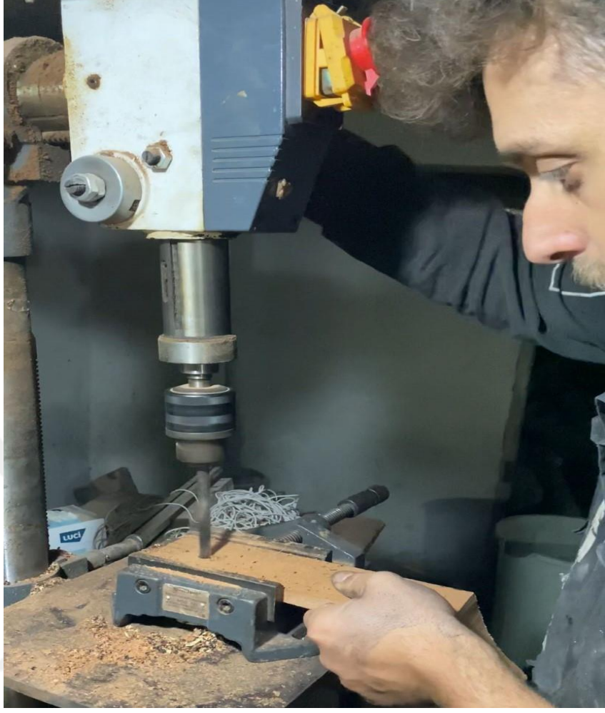
Görsel 40: Manyetik Testere İle Dillik Yuvasının Açılması
