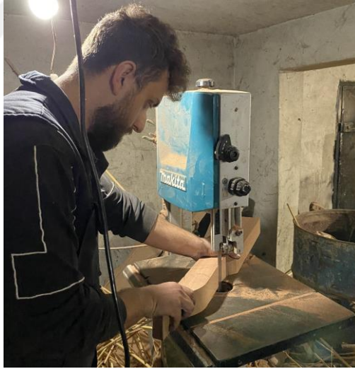
Görsel 36: Şerit Testere ile Nav Formunun Çıkartılması
