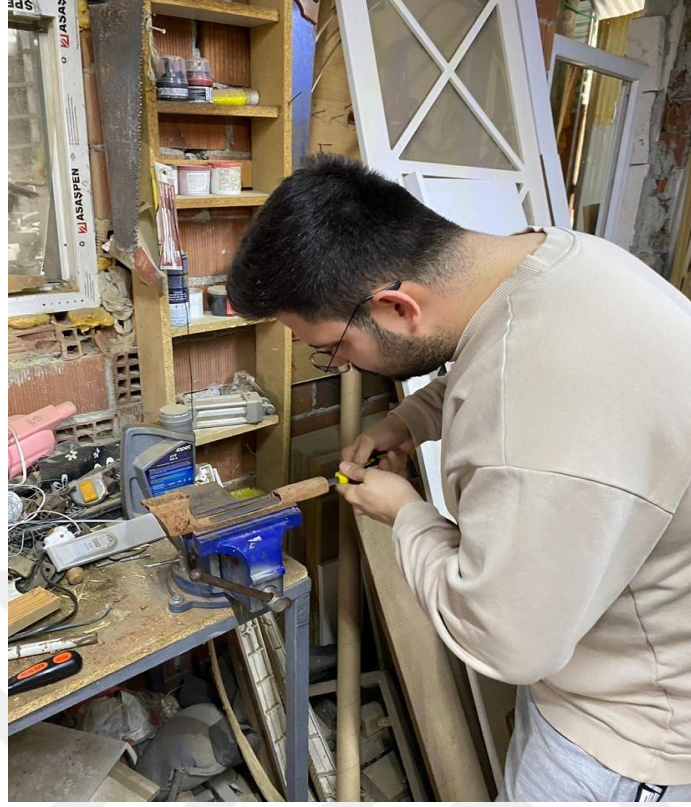
Görsel 44: Analık ve Dillik Yuvasının Törpülenmesi
