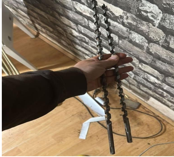
Görsel 34: 10 ve 11 mm'lik Silindir Matkap Uçları
