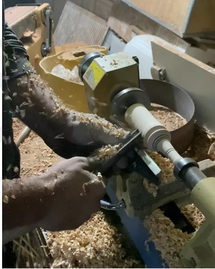
Görsel 58: Dudulanın Torna Üzerinde İşlenmesi
