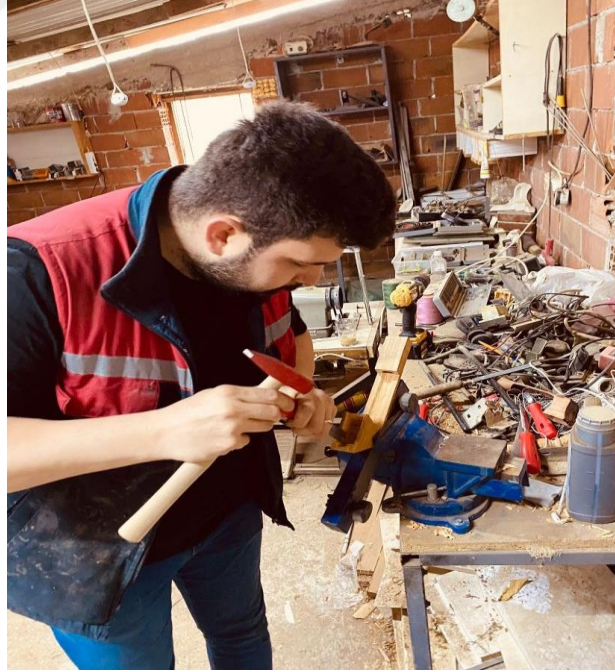
Görsel 43: İskarpela ile Oyma İşlemi
