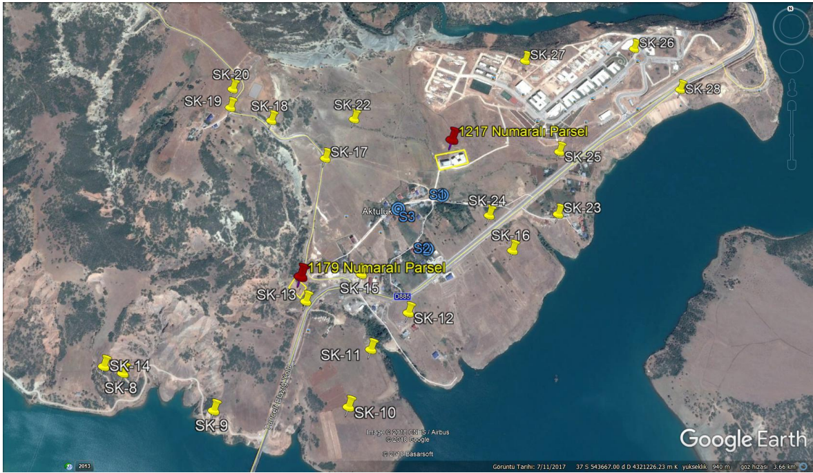
Şekil 3.3. İnceleme alanı ve civarında YAS temini amacıyla açılmış derin sondaj kuyuları Google earth görüntüsü. (S1, S2 ve S3) ile Tunceli Belediyesi Merkez (2. Bölge) İmar Planına Esas Jeolojik-Jeoteknik Etüt Raporu (2015) Kapsamında açılan zemin araştırma sondajlarının (SK-1 ile SK-28 arası) Google Earth üzerine işaretlenmiş konumları.
