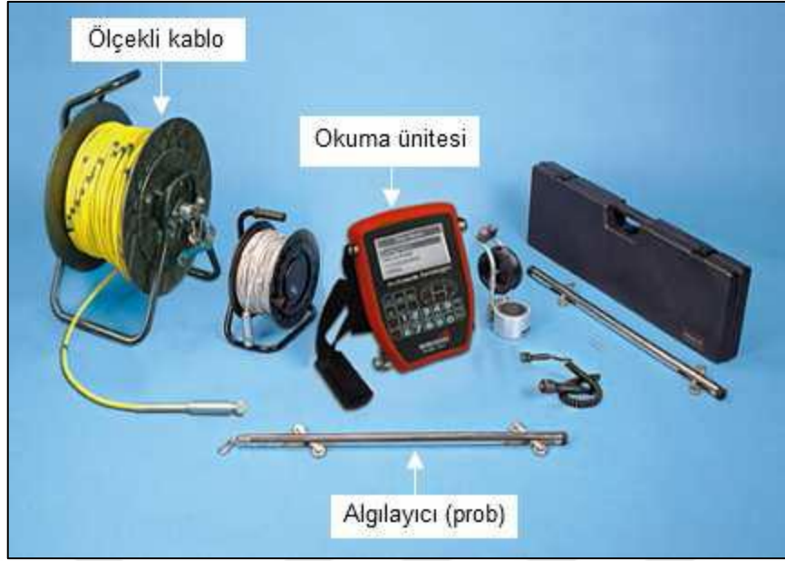
Şekil 2.5. İnklinometre cihazı bileşenleri (Sisgeo, 2006).
