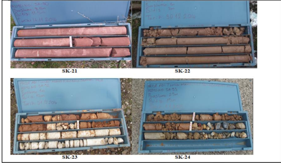
Şekil 2.3. Yapılan sondajlarda alınan karot numuneler (Tunceli 2.bölge imara esas jeolojik ve jeoteknik etüd raporundan düzenlenerek alınmıştır).
