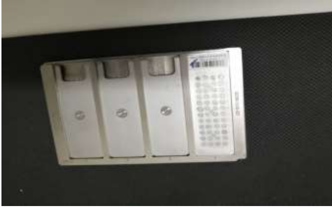
Resim 2.7. MALDI-TOF MS plakasının hazırlanma aşaması bittikten sonra kurumaya bırakılmış görüntüsü
