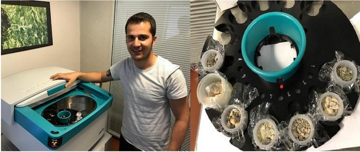
Şekil 2.1. EDXRF Spektrometresi ve spektrometreye numune yerleştirilmesi
