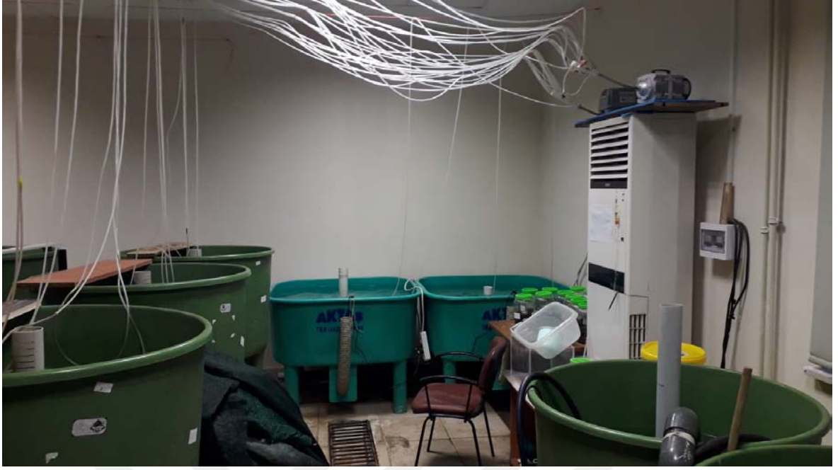
Resim 2.2. Deneme tankları, hava motoru ve hava hortumları
