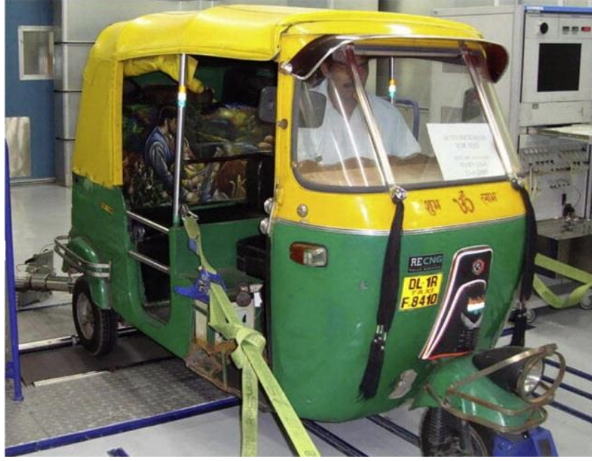
Şekil 4.1. Dinamometre testi yapılan tuk-tuk tipi araç (Grieshop ve ark. 2012)
