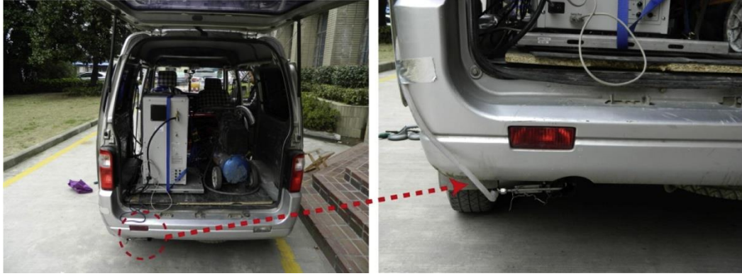
Şekil 4.3. Bir araç içerisine yerleştirilen online ölçümleme cihazlarının gösterimi (Li ve ark. 2013)
