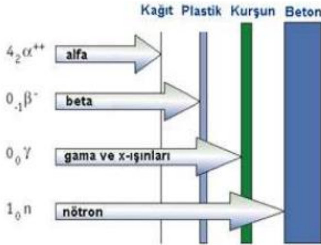
Şekil 25. Farklı Radyasyon Türlerine Göre Zırhlama Malzemeleri (Sürücü ve Subaşı, 2021)
