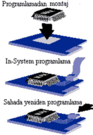
Şekil 4.4. Montaj ve Sahada Programlanmanın Şematik Gösterimi
