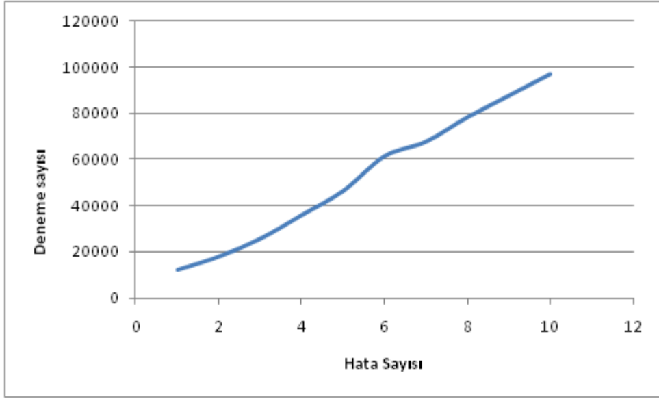
Şekil 5.9. B Harmanlayıcısında 10dB için Hata Grafiği
