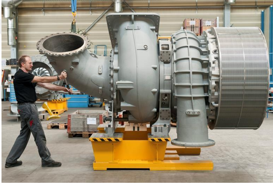
Şekil 1.3. Bir gemi motorunun büyük üniteye sahip turboşarj sistemi (Anonymous 2024b).
