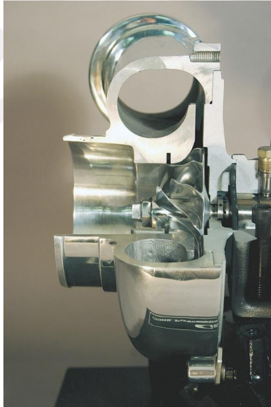
Şekil 1.8. Turboşarj sistemi kompresör kısmının kesit alınmış gösterimi (Miller 2008; Anonymous 2024c).
